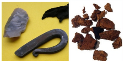
Огниво — приспособление для получения огня. Широко применялось до появления спичек. Простейшее огниво состоит из кресала (как правило — напильника с очень мелкой насечкой), «кремня» (минерал пирит, состоящий из сульфидов железа) и трута . Сноп высекаемых искр, получаемый от удара кремня о кресало, воспламеняет трут, и в дальнейшем тлеющий трут «раздувается» при помощи губ или, при хорошем качестве трута, немедленно вспыхивает пламя, которое на ветру не гаснет...
